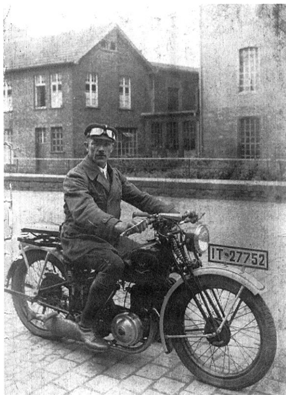
Links: Johannes Kraft mit seiner "Walter". Das Motorrad war mit einem englischen "Willes-Motor" ausgestattet und hatte bereits eine elektrische Beleuchtungs- einrichtung mit Batterie. Das Bild wurde 1928 in Fulda in der Leipziger Straße aufgenommen.
