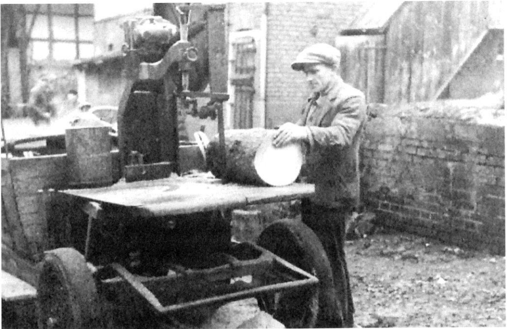
Unten: Heinrich Eifert mit seiner selbst- konstruierten, selbstfahrenden Bandsäge, unterwegs beim Holz- schneiden.
